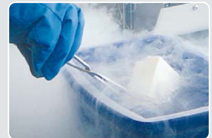
Vorversprödung des Materials im Edelstahl-Mahlbecher in flüssigem Stickstoff
